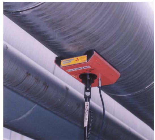
— 中性子水分計による現地測定の状況 —
