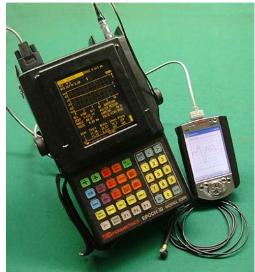
現場用データ採取システム
