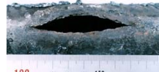
<短時間クリープによる損傷例>
